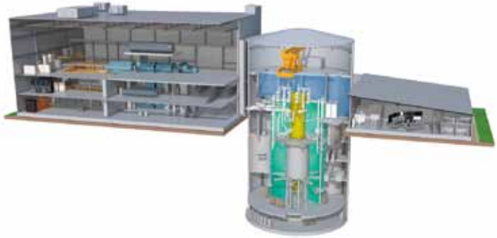
小型軽水炉 BWRX-300 写真提供:日立GEニュークリア・エナジー(株)
