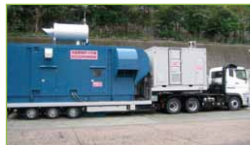
空冷式非常用発電装置 写真提供:関西電力(株)
